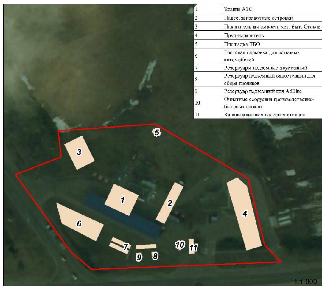
Рисунок 2 – План площадки АЗС после реконструкции
